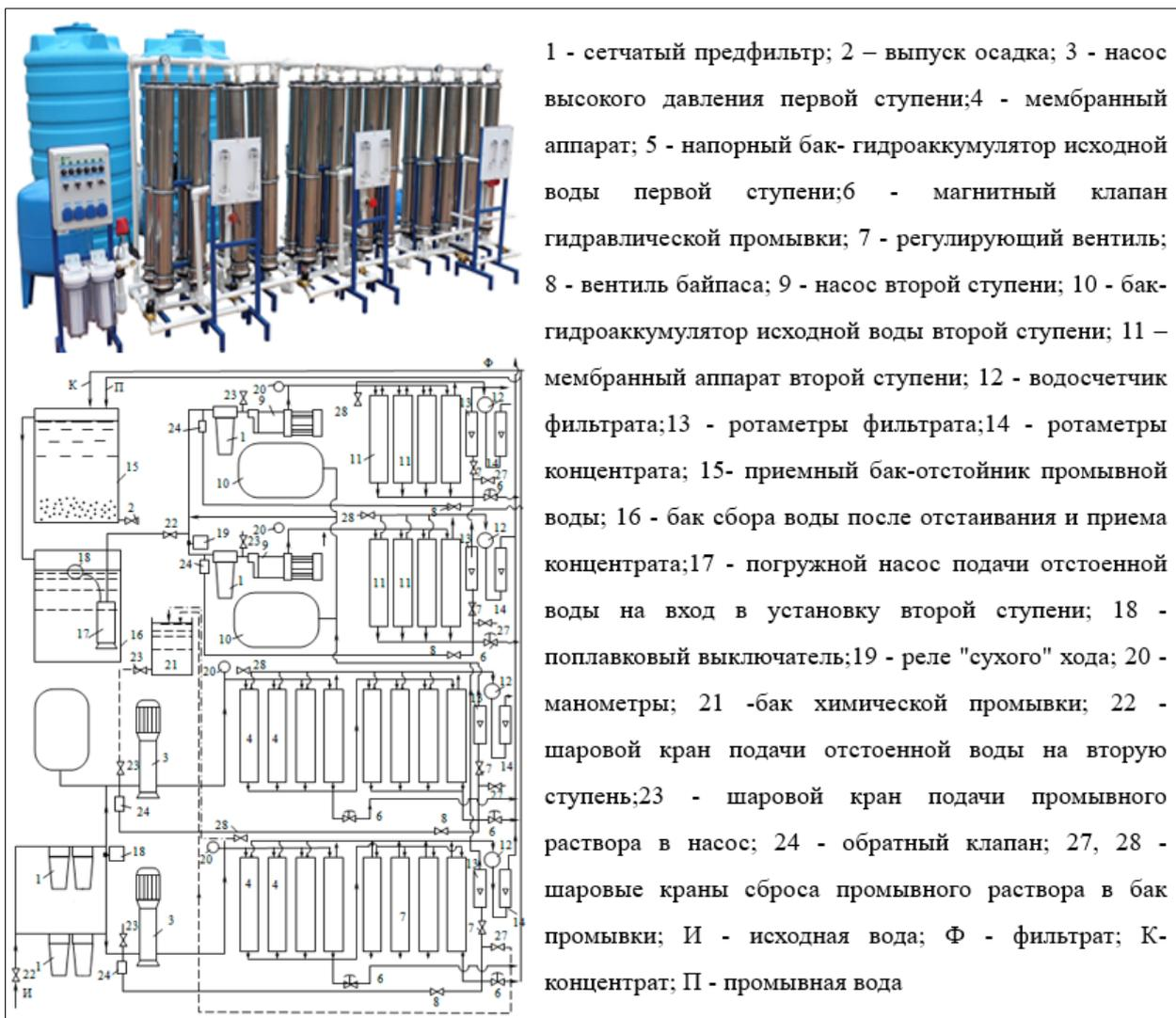
Рисунок 1.16. Установка мембранной очистки ливневых сточных вод
