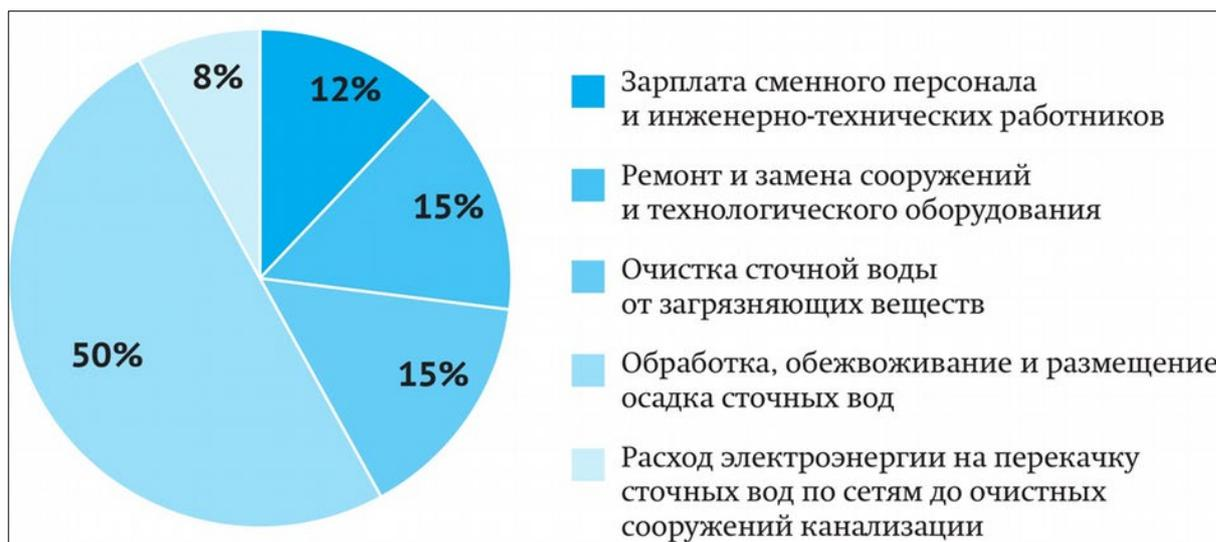
Рисунок 1.9. Усреднённая структура эксплуатационных расходов на очистку коммунально-бытовых сточных вод
