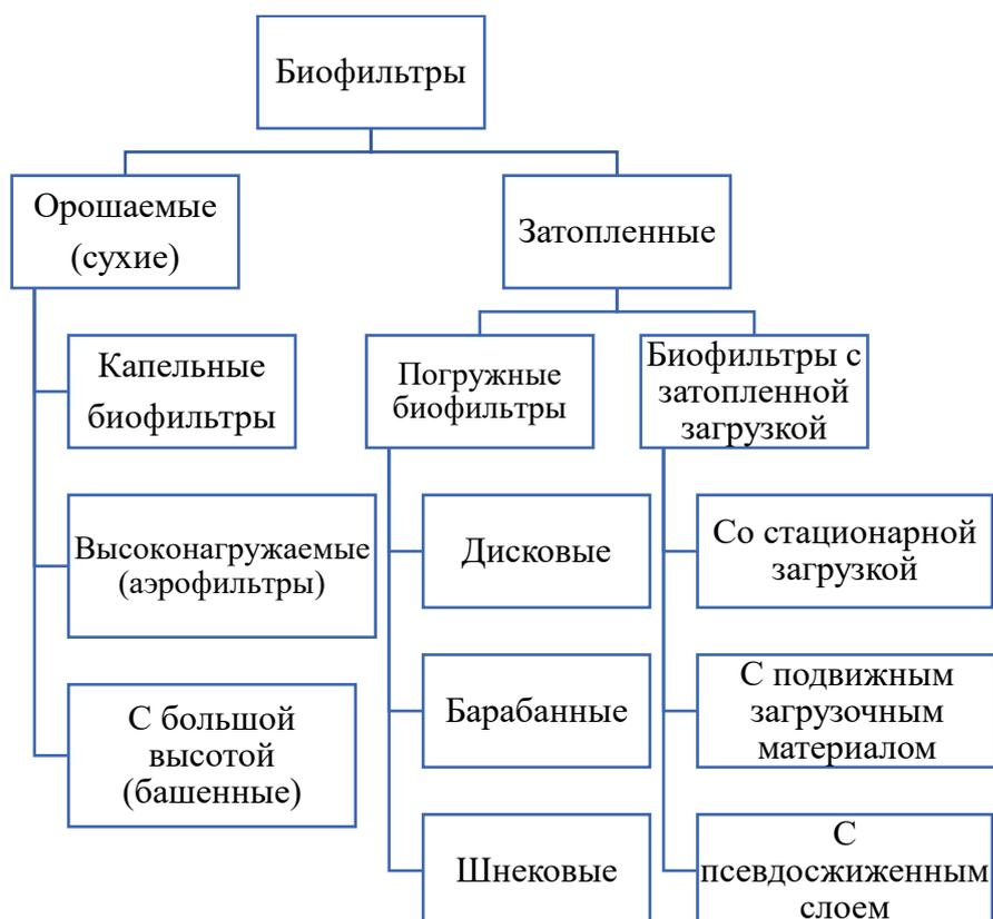
Рисунок 1.1 - Классификация биофильтров по типу контакта загрузочного материала с водой
