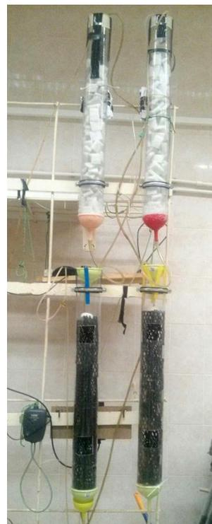
Пилотная установка с загрузочными материалами «Ячеистый полимер» и «Пространственная сетка»
