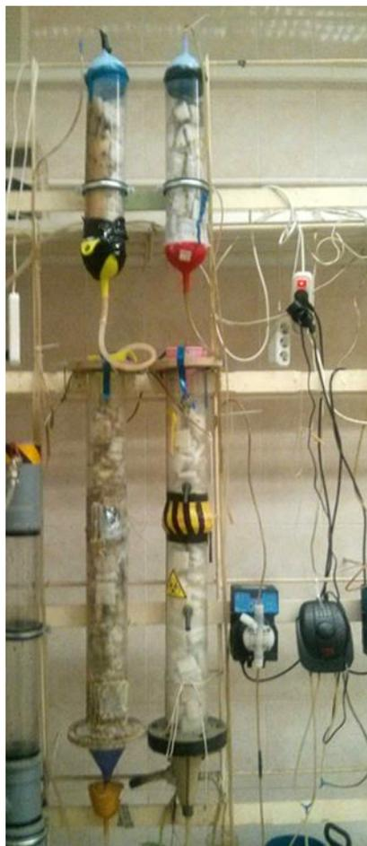
Рисунок 2.69 - Лабораторная модель с четырьмя зонами биофильтрации с загрузочным материалом «Ячеистый полимер» с соотношением зон денитрификации и нитрификации 25 и 75 %
