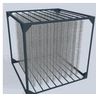
Рисунок 1.29 - Ершовый загрузочный материал производства НПО «Агростройсервис» [46]
