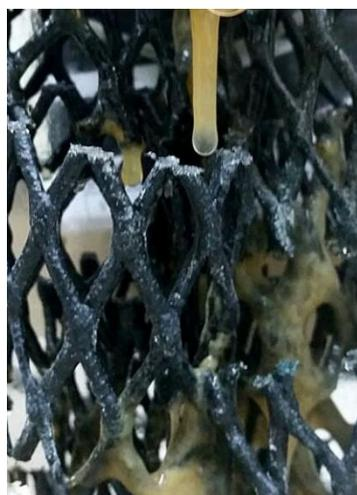
Рисунок 2.6 - Стандартный режим: несколько элементов загрузочного материала «Пространственная сетка», середина реактора
