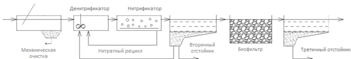
Рисунок 1.34 - Принципиальная схема очистки сточных вод с биофильтром в качестве сооружения доочистки
