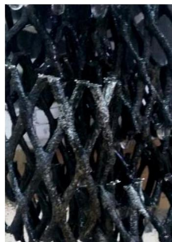
Рисунок 2.7 - С рециркуляцией нитратной воды: несколько элементов загрузочного материала «Пространственная сетка», середина реактора
