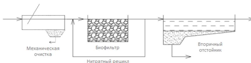
Рисунок 1.32 - Принципиальная схема очистки сточных вод с биофильтром в качестве основного реактора
