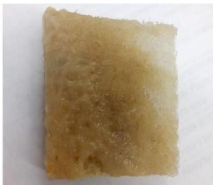
Рисунок 2.8 - Стандартный режим: элемент загрузочного материала, извлеченный из середины реактора
