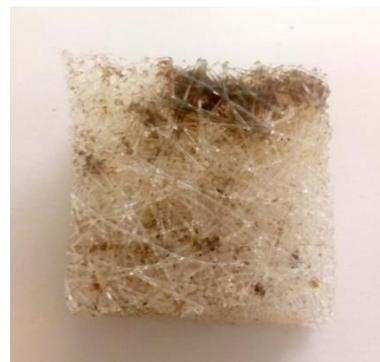
Рисунок 2.9 - С рециркуляцией нитратной воды: элемент загрузочного материала, извлеченный из середины реактора
