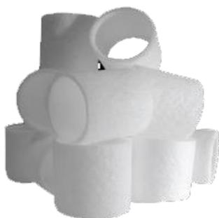
Рисунок 1.15 - Кольца Рашига, полиэтиленовые пористые цилиндры. Наружный диаметр– 120 мм, толщина стенки – до 10 мм.
