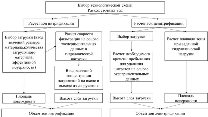
Рисунок 6. Блок-схема расчета зон нитрификации и денитрификации
