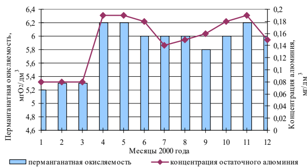
Рисунок 2.15 - Содержание перманганатной окисляемости и концентрации остаточного алюминия в воде, прошедшей очистку на ВОС
