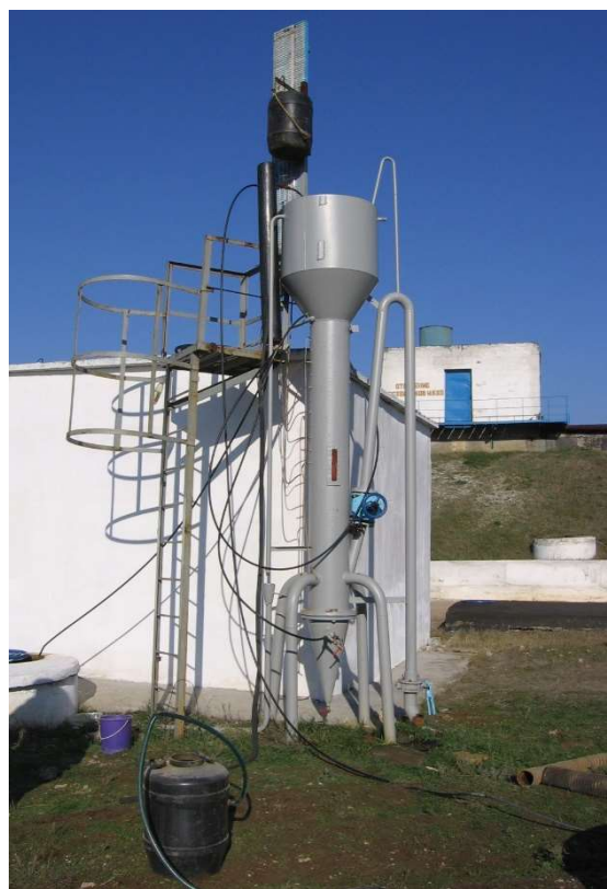
Рисунок 3.1 – Опытно-промышленная фильтровальная установка (а-рисунок; б-фотография размещения установки на площадке ВОС МГУ «Жаворонки»)
